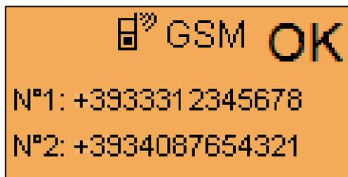
I 2 numeri impostati saranno abilitati ad avviare/fermare il motore, inviare messaggi per la richiesta di informazioni e ricevere i messaggi di allarme.
